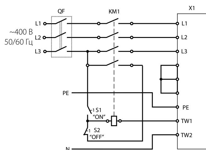
X1 – колодка клемна, QF – автоматичний вимикач, KM1 – магнітний пускач, S1, S2 – кнопки керування (QF, KM1, S1, S2 до комплекту постачання не входять).
