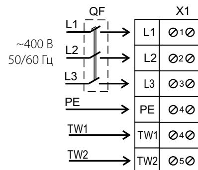
Схема підключення вентиляторів ВКПФ(I) 4Е 400\*200; ВКПФ(I) 4Е 500\*250; ВКПФ(I) 4Е 500\*250; ВКПФ(I) 6Е 500\*300; ВКПФ(I) 6Е 500\*300; ВКПФ(I) 4Е 600\*300; ВКПФ(I) 6Е 600\*300; ВКПФ(I) 4Е 600\*350; ВКПФ(I) 6Е 600\*350 з однофазним двигуном
