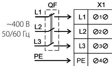
Схема підключення ВКП/ВКПІ 4Д 500\*300 (другий варіант), ВКП/ВКПІ 4Д 600\*300; ВКП 4Д 700\*400; ВКП 4Д 800\*500 із трифазним двигуном
