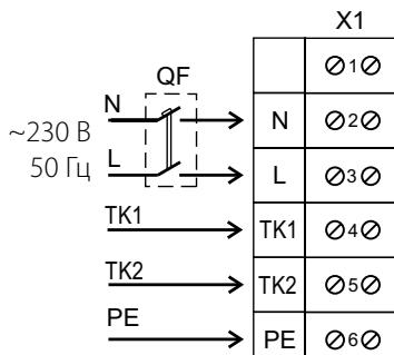
Схема підключення вентиляторів ВКП 4Д 600\*350; ВКПФ(I) 4Д 400\*200; ВКПФ(I) 4Д 500\*250; ВКПФ(I) 4Д 500\*300; ВКПФ(I) 6Д 600\*320; ВКПФ(I) 6Д 500\*300; ВКПФ(I) 4Д 600\*300; ВКПФ(I) 6Д 600\*300; ВКПФ(I) 4Д 600\*350; ВКПФ(I) 6Д 600\*350; ВКПФ(I) 4Д 700\*400; ВКПФ(I) 6Д 700\*400; ВКПФ(I) 4Д 800\*500; ВКПФ(I) 6Д 800\*500; ВКПФ(I) 8Д 800\*500; ВКПФ(I) 6Д 900\*500; ВКПФ(I) 8Д 900\*500; ВКП 4Д 1000\*500; ВКП 6Д 1000\*500; ВКПФ(I) 6Д 1000\*500; ВКПФ(I) 8Д 1000\*500
