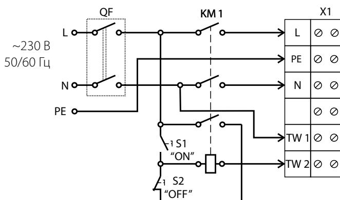
Рекомендована схема підключення трифазного двигуна з використанням термозахисту
