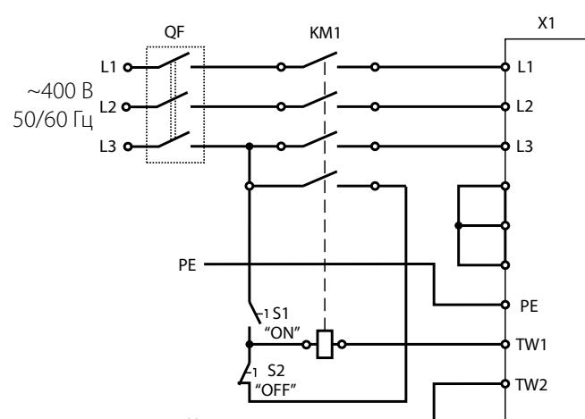
X1 – колодка клеммная, QF – автоматический выключатель, KM1 – магнитный пускатель, S1, S2 – кнопки управления (QF, KM1, S1, S2 в комплект поставки не входят).
