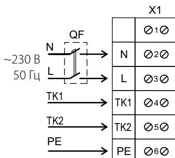
Схема подключения ВКП/ВКПИ 4Д 500\*300 (второй вариант), ВКП/ВКПИ 4Д 600\*300; ВКП 4Д 700\*400; ВКП 4Д 800\*500 с трехфазным двигателем
