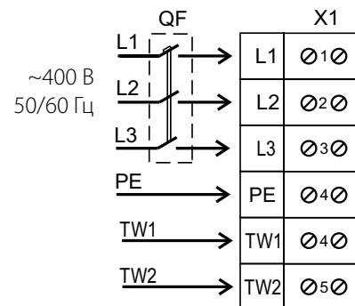
Схема подключения вентиляторов ВКП 4Д 600\*350; ВКПФ(И) 4Д 400\*200; ВКПФ(И) 4Д 500\*250; ВКПФ(И) 4Д 500\*300; ВКПФ(И) 6Д 600\*320; ВКПФ(И) 6Д 500\*300; ВКПФ(И) 4Д 600\*300; ВКПФ(И) 6Д 600\*300; ВКПФ(И) 4Д 600\*350; ВКПФ(И) 6Д 600\*350; ВКПФ(И) 4Д 700\*400; ВКПФ(И) 6Д 700\*400; ВКПФ(И) 4Д 800\*500; ВКПФ(И) 6Д 800\*500; ВКПФ(И) 8Д 800\*500; ВКПФ(И) 6Д 900\*500; ВКПФ(И) 8Д 900\*500; ВКП 4Д 1000\*500; ВКП 6Д 1000\*500; ВКПФ(И) 6Д 1000\*500; ВКПФ(И) 8Д 1000\*500
