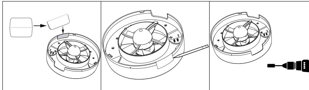
**Увага! Для вирізання отвору використовуйте електроінструмент з абразивною насадкою або відповідний ручний інструмент.**
