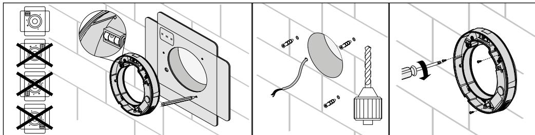
5. Заведіть кабель живлення через гермоведення обраним способом та підключіть вентилятор до мережі відповідно до схеми підключення.
