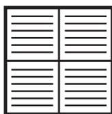
ОРК1 – параллельное расположение направляющих воздушного потока
