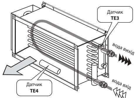
Опалювальний водяний контур має забезпечувати всі необхідні функції для регулювання та безпеки водяного нагрівача, а також для забезпечення достатньої температури та витрати теплоносія згідно специфікації в проектній документації повітroteхнічного обладнання.
