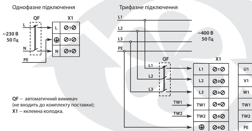
Установка МПА ... В LCD підключається через клемну колодку, яка розташована в блоці керування, відповідно до схеми зовнішніх підключень та позначення клем (див. посібник користувача САК, схеми зовнішніх підключень для установок МПА ... В).
