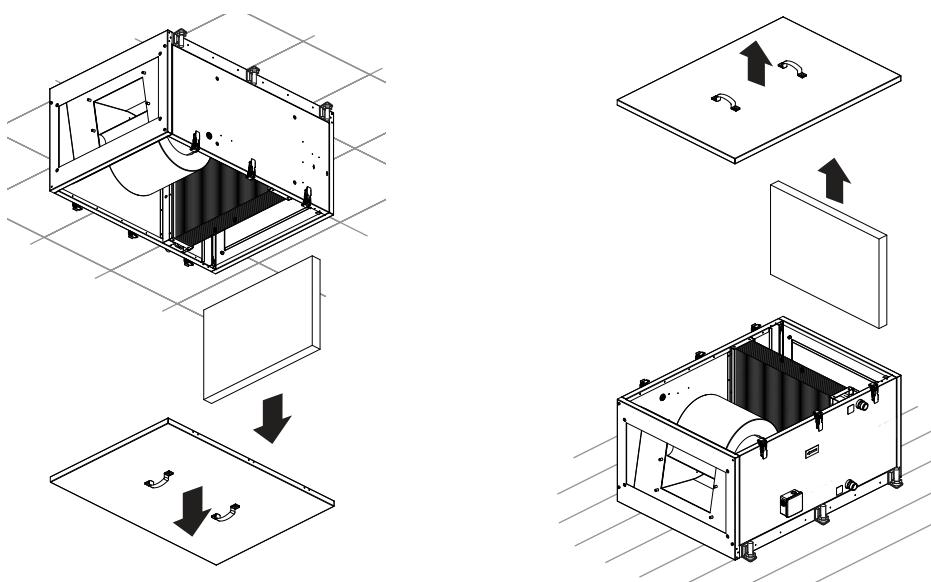
Забруднені фільтри підвищують опір повітря, що призводить до зменшення подачі припливного повітря в приміщення. Фільтри необхідно чистити в міру забруднення, але не рідше 3-4 рази на рік. Дозволяється чищення фільтрів пилососом. Після дворазового чищення фільтри необхідно замінити. Для придбання нових фільтрів зверніться до продавця.
