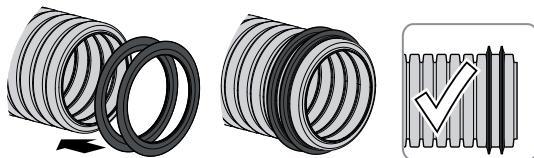
**УВАГА!** Перед заливанням повітропроводів бетоном слід ущільнити стик між повітропроводом та фланцем, а також стик між фланцем та заглушкою стрічкою холодної усадки.
