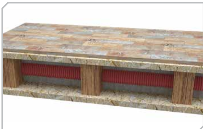
Внутри деревянных перекрытий через балки
