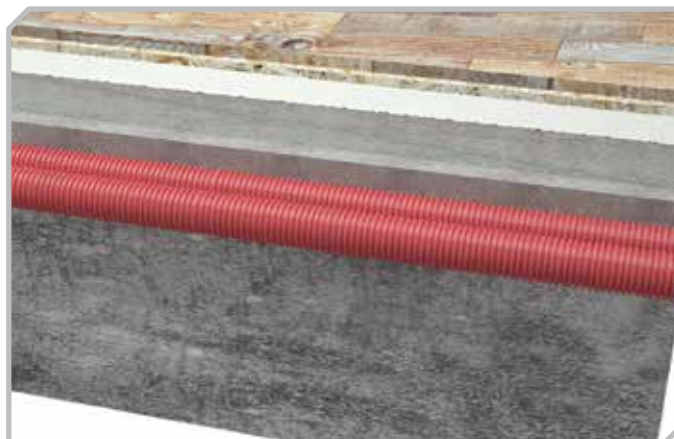
Заливка каналов в стяжку пола
