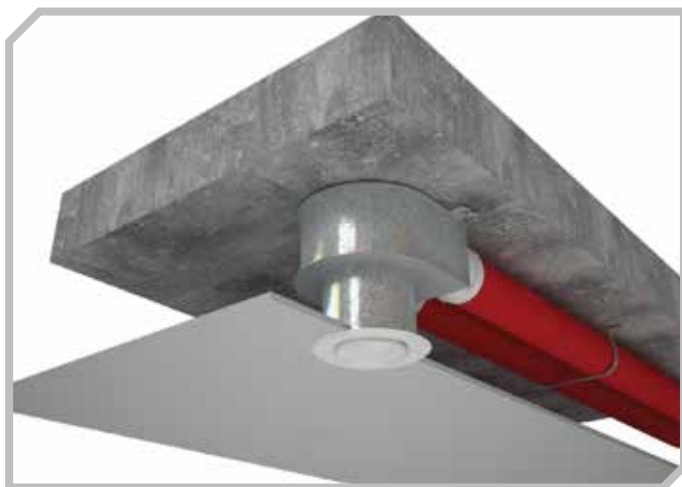
Монтаж потолочного пленума с круглой решеткой в пространстве над подвесным потолком
