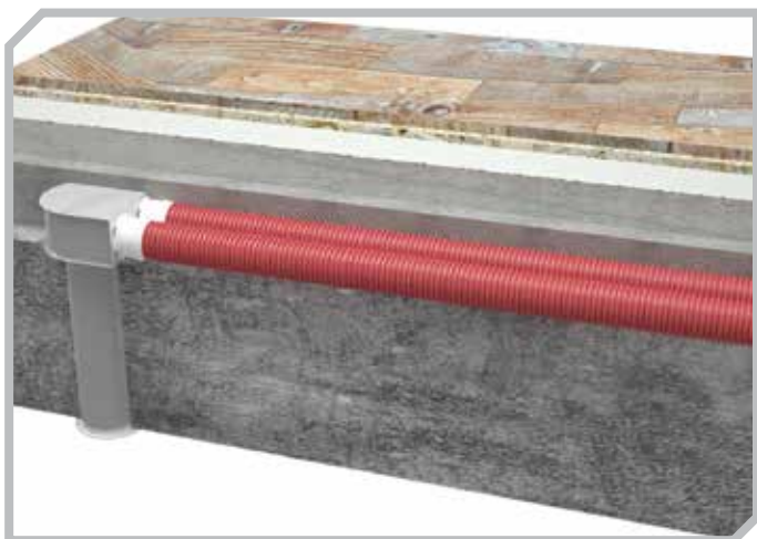
Заливка потолочного пленума стяжкой пола
