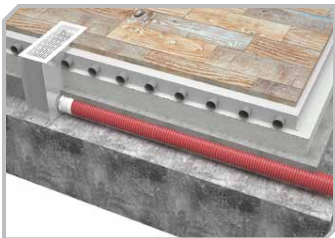
Заливка напольного пленума стяжкой пола (в комбинации с системой «теплый пол»)
