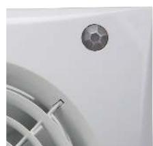
Модель оснащена инфракрасным датчиком движения и регулируемым таймером (1-30 мин.). Вентилятор включается автоматически, когда датчик фиксирует движение в радиусе 4 метров от вентилятора и выключается по прошествии времени, заданного на таймере. Угол обзора датчика движения составляет около 90°.
