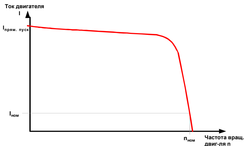
Рисунок 1-1: Типичные параметры пускового тока трёхфазного асинхронного двигателя
