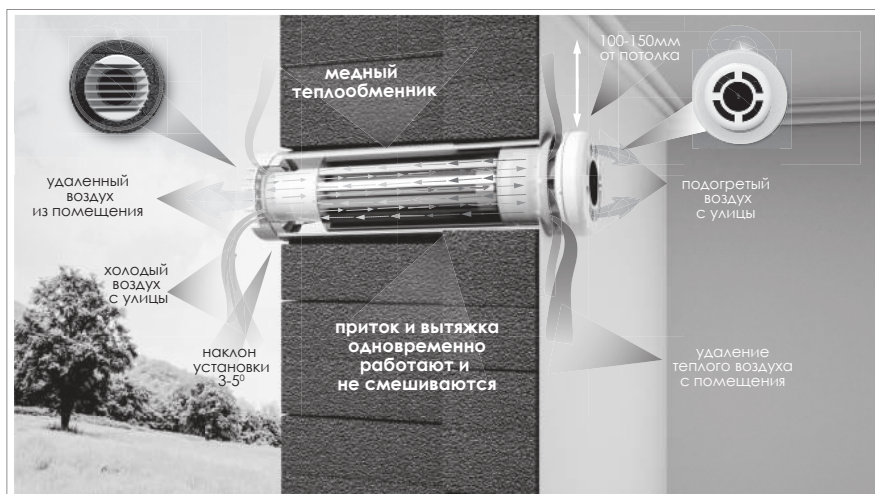
Рис.1. Принцип работы рекуператора PRANA-150, PRANA-200С, PRANA-200G
