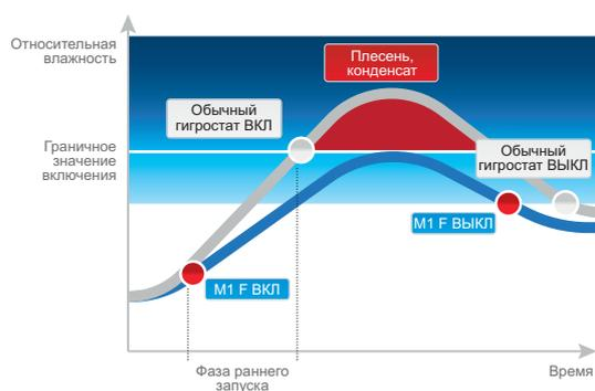
При **нормальном** протекании процесса повышения уровня влажности (например, при стирке) вентилятор включается автоматически при достижении определенного граничного значения и продолжает работать до снижения уровня влажности на 10%.
