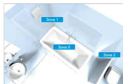
*Возможен монтаж в зоне 1 (согласно DIN VDE 0100-701).*
