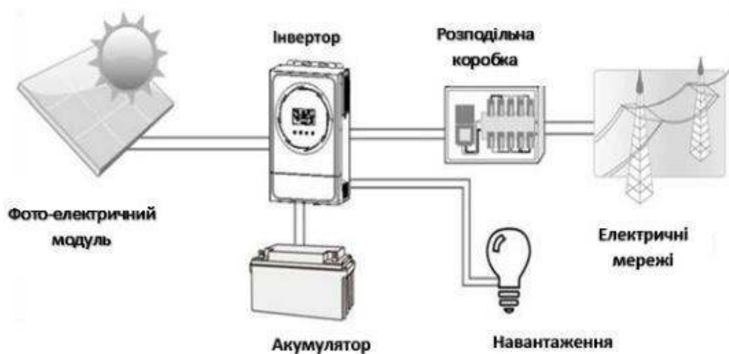
Малюнок 1 Загальний огляд фотоелектричної системи
