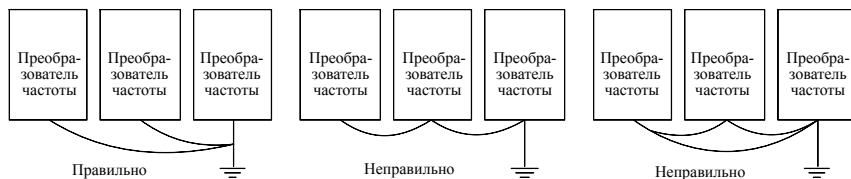
Рис. 3.2 Схема заземления
