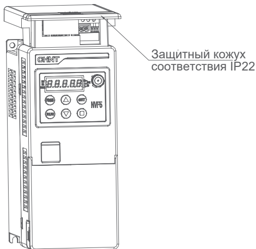
Внешний вид преобразователя частоты после установки кожуха.
