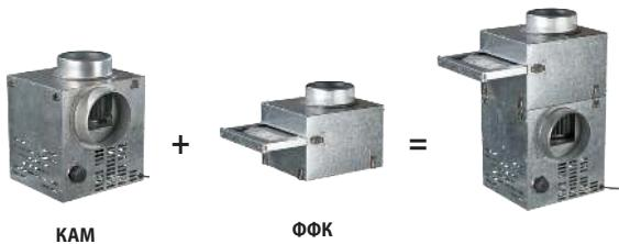
Коли температура повітря довкола каміна досягає заданого значення, вентилятор автоматично вмикається (рис. 2б) і розподіляє очищене фільтром ФФК тепло повітря від каміна в інші приміщення. А вимикається (рис. 2а), коли температура опускається нижче заданого значення.
