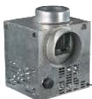
Коли температура повітря у просторі довкола каміна досягає заданого значення, вентилятор автоматично вмикається (рис. 1б) і розподіляє тепло повітря від каміна в інші приміщення. А вимикається (рис. 1а), коли температура опускається нижче заданого значення.
