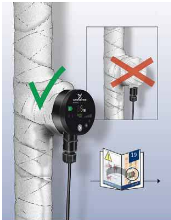
Рис. 5 Изоляция корпуса насоса
