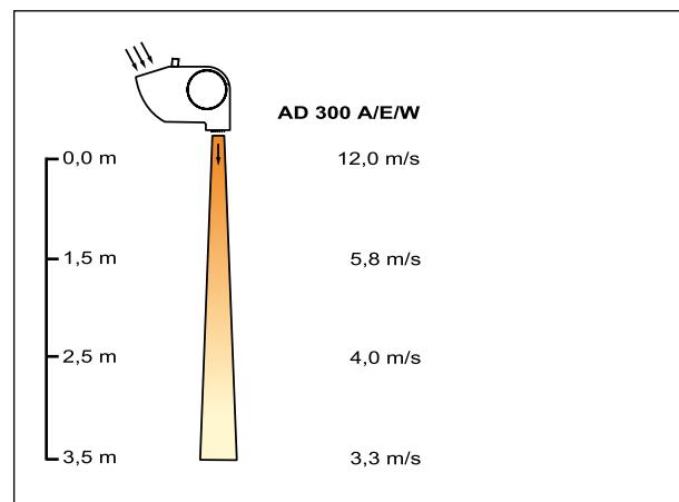
**Технические параметры | Thermozone AD 300 A без обогрева**
