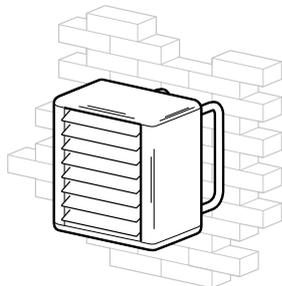
SWH, установленный на монтажных скобах на стене
