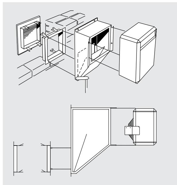
Рисунок 2: Общий вид Panther с камерой смешения.
