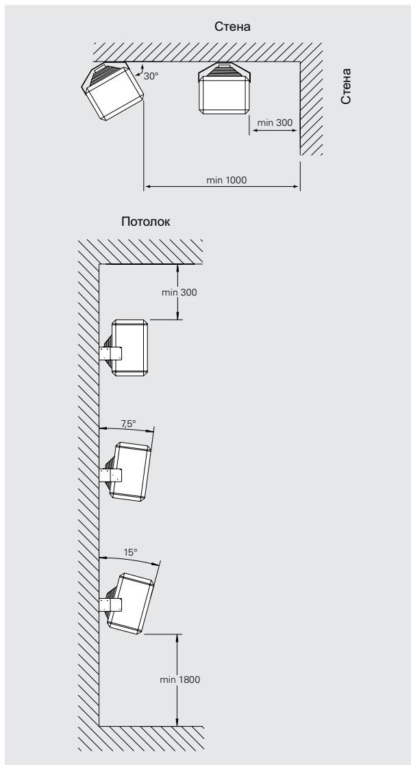
Рисунок 1: Минимальные расстояния при подвеске на стену.
