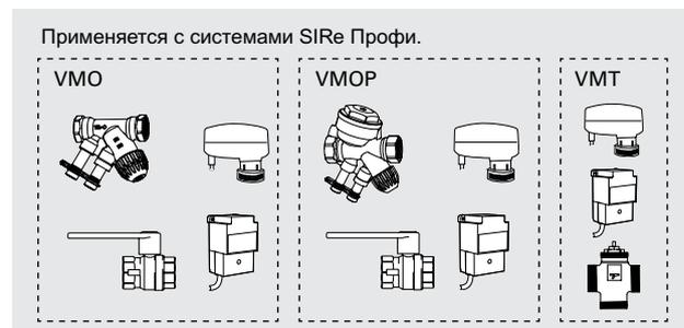
Комплекты клапанов VOS(P), VOT, VMO(P) или VMT используются для регулировки расхода, подробную информацию можно найти в разделе "Приборы управления".
