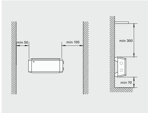
Рисунок 1: Минимальные расстояния при подвеске на стену.
