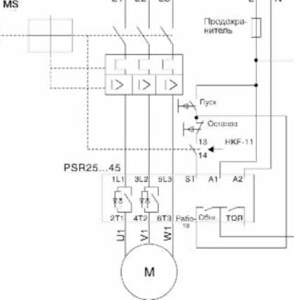
С предохранителями, контактором и защитой от перегрузки
