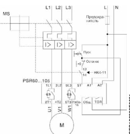
С предохранителями, и защитой от перегрузки
