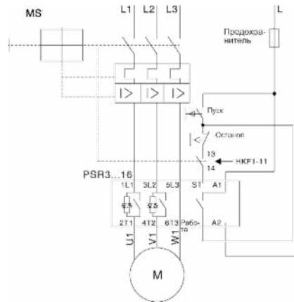
С предохранителями, контактором и защитой от перегрузки
